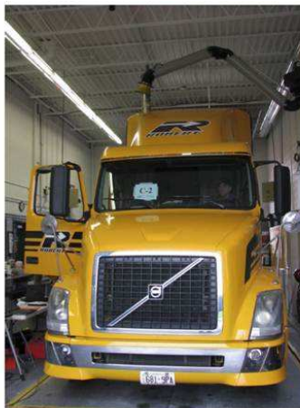
Figure 5. Véhicule d'essai pendant les mesurages des émissions polluantes
